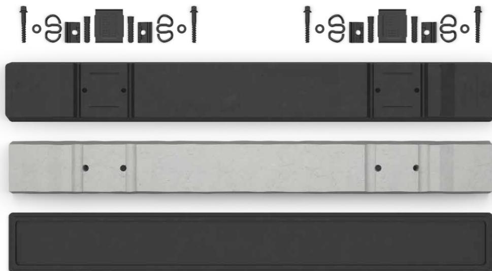
Le traverse Greenrail™ sono costituite da una cover esterna realizzata con una miscela ottenuta da pneumatici fuori uso (di seguito definito PFU) e plastica riciclata e da una struttura interna in calcestruzzo armato precompresso. Le traverse Greenrail garantiscono tutte le caratteristiche meccaniche delle traverse ferroviarie, offrendo i seguenti vantaggi:
